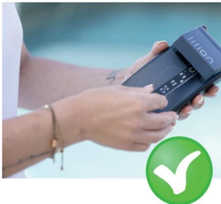
Der SensoStick wird stets mit der bedruckten Seite nach oben in einen der beiden Slots eingeführt.
