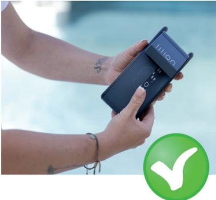
Der SensoStick wird immer in die Öffnung der LILIAN-Klappe von hinten eingeführt.
