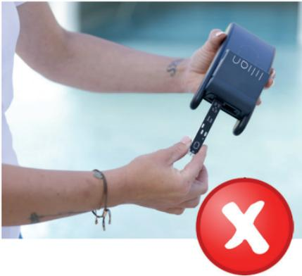
In diesem Beispiel wird der SensoStick aus der falschen Richtung eingeführt.
