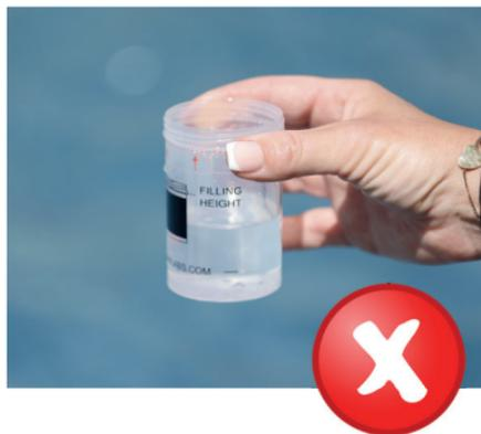
Verwenden Sie nur den mitgelieferten Messbecher und achten Sie auf den Wasserfüllstand. Hier ist der Becher nicht ausreichend gefüllt. So kann das LILIAN die Wasserprobe nicht korrekt in den SensoStick pumpen, was zu einer Fehlermeldung des Geräts führt.
