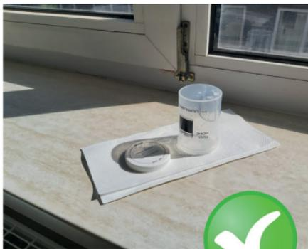
Lagern Sie die Becher am besten offen und mit der offenen Seite nach unten z.B. auf Küchenrolle, bis diese trocken sind. Wenn Sie die Becher mit einem Tuch trocken wischen möchten, achten Sie bitte darauf, keine Partikel und Verunreinigungen in den Becher einzubringen. Wechseln Sie die Messbecher nach spätestens einem Monat der Nutzung aus.
