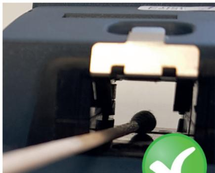
Am einfachsten reinigen Sie die Messkanäle mit einem mit Isopropanol benetzten Wattestäbchen. Führen Sie bei der Reinigung leichte, kreisende Bewegungen im Messschacht aus.
