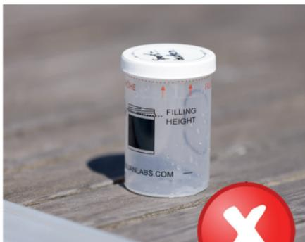
Der Messbecher muss vor und nach jeder Messung ausreichend gespült und gereinigt werden. Die feuchten Becher nicht mit dem verschlossenen Deckel lagern. Dadurch können sich Keime bilden, welche bei der nächsten Messung zu einem verfälschten Chlorwert führen können.
