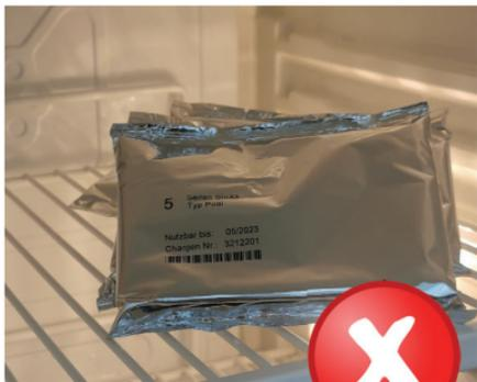
Die Lagertemperatur für die SensoSticks beträgt 0-30 °C. Wir empfehlen trotzdem nicht die Lagerung im Kühlschrank, da für die Nutzung diese sich erstmal auf Raumtemperatur erwärmen müssen. Die SensoSticks beschlagen andernfalls und die Messung kann verfälscht werden.
