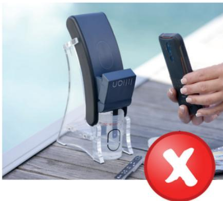
Die Klappe des Handmessgeräts muss bei jeder Messung geschlossen werden. Damit wird der Einfluss von Streulicht minimiert.
