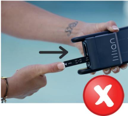
Der SensoStick wird immer von hinten nach vorne aus einem der beiden Slots des LILIAN Messgerätes herausgezogen.
