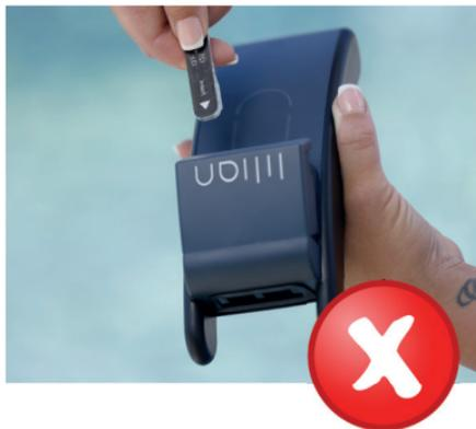
Der Teil des Sticks, der in der Wasserprobe steckt, darf nicht berührt werden. Das freie Chlor der Wasserprobe reagiert sonst mit Spuren des Fingerabdrucks auf dem SensoStick und Sie messen erhöhte gebundene Chlorwerte.
