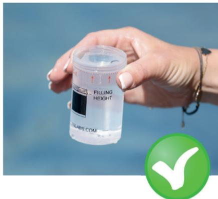
Der Becher sollte bis zum Gewinde mit der Wasserprobe gefüllt sein.
