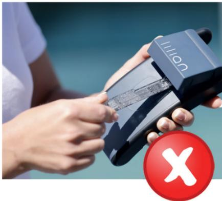
Der SensoStick darf nicht mit der bedruckten Seite nach unten eingeführt werden.
