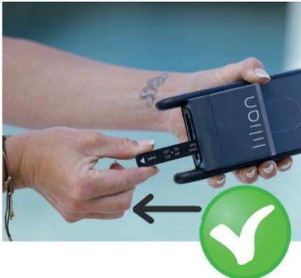
Achten Sie darauf, den SensoStick nicht von vorne nach hinten aus dem Schacht zu entnehmen.
