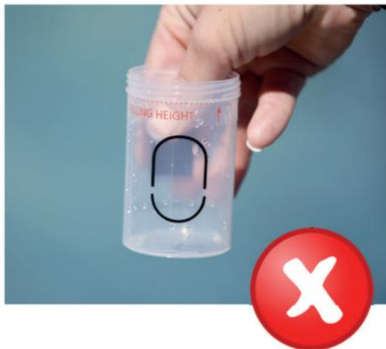
Fassen Sie bitte nicht in den Probenbecher! Rückstände ihres Fingerabdrucks führen dazu, dass das freie Chlor in der Wasserprobe zu gebundenem Chlor reagiert. Das Messergebnis ist damit verfälscht.
