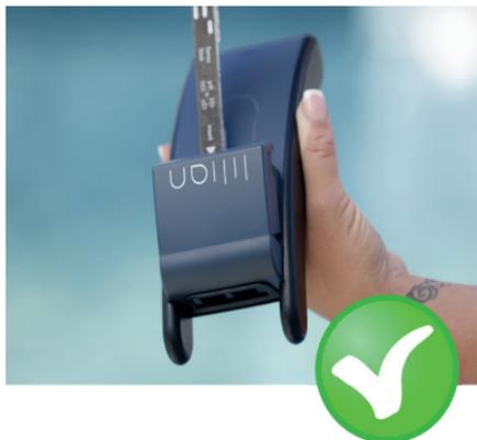
Der Stick wird beim Einführen in das Messgerät immer nur hinten berührt, um Abweichungen im Messergebnis zu verhindern.
