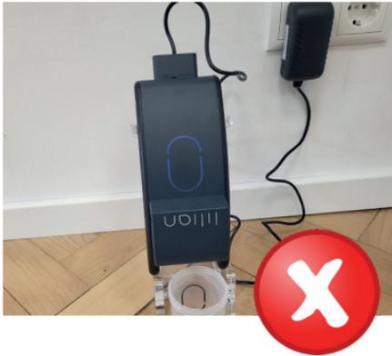
Während einer Messung darf aus Sicherheitsgründen das Gerät nicht geladen werden. Entfernen Sie daher den Ladestecker während der Messung.
